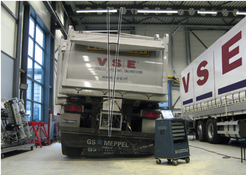
▲ De hardware die actief bewegende lading tegengaat, zit in de rvs kist in het midden achter op de trailer.
